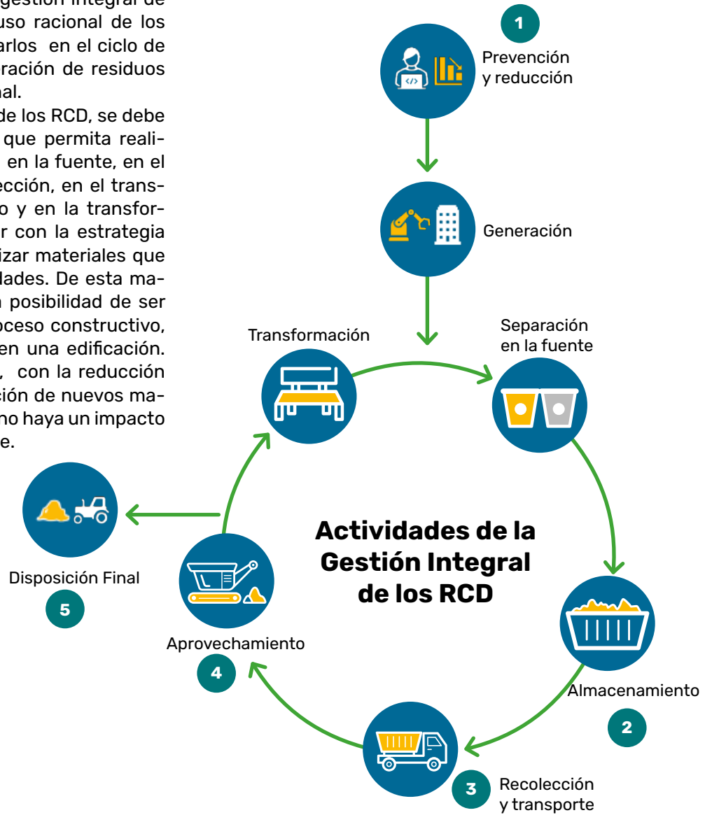
Ilustración 1.2. Actividades de gestión integral de los RCD. Fuente: Artículo 4° Res. 472/2017. Elaboración: Propia
